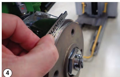
Поставете ключа на капака на двигателя срещу барабана
