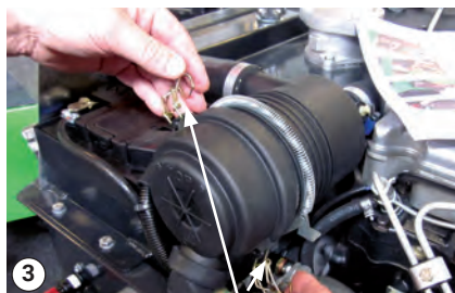
3 Разхлабване на корпуса на филтъра
