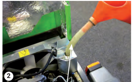
Наливане на охлаждаща течност
