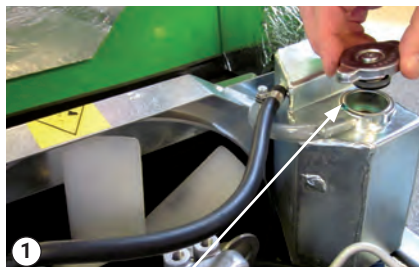
Проверка на охлаждащата течност
