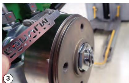
Поставете ключа на капака на двигателя срещу барабана
