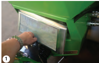
Монтиране на капака на масления охладител
