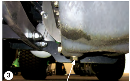
Сваляне на долния винт
