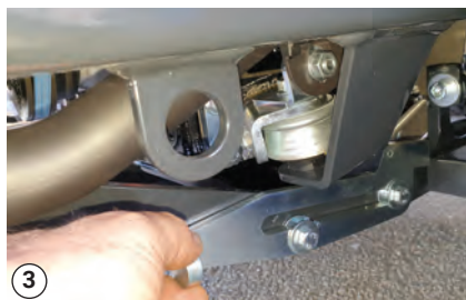
Деблокиране на заден повдигач
