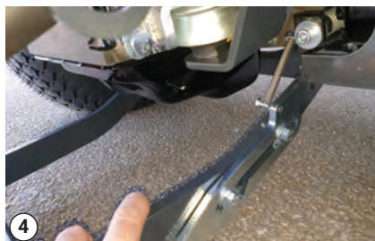
Блокиране на заден повдигач
