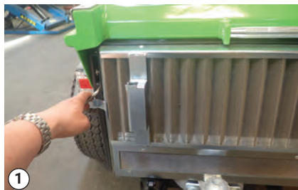
1 Сваляне на капака на радиатора
