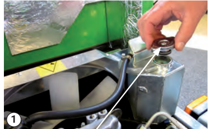
Капачка на разширителния съд на охлаждащата течност
