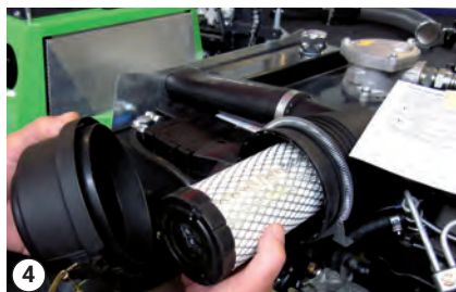
4 Сваляне на филтърния елемент на въздушния филтър
