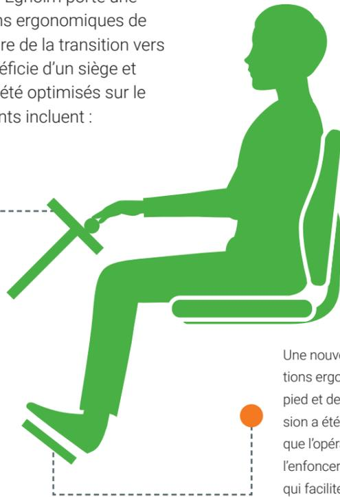
La position de la colonne/du volant de direction a été rapprochée de 4 cm du pare-brise pour agrandir l'espace en faveur de l'opérateur.
