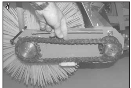
Pas de kettingspanning aan - speling van 4-5 mm
