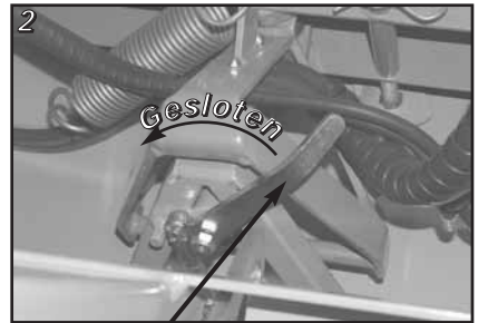
Vergrendelen van veiligheidshendel op het A-frame - open
